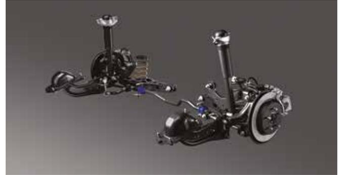
La nuova e più rigida piattaforma GA-C offre da questo punto di vista un'ottima base di partenza. La precisione è offerta da un cuscinetto del sistema MacPherson realizzato specificamente per il Toyota C-HR e progettato per ridurre drasticamente gli attriti dello sterzo, assicurando un movimento fluido e preciso.
