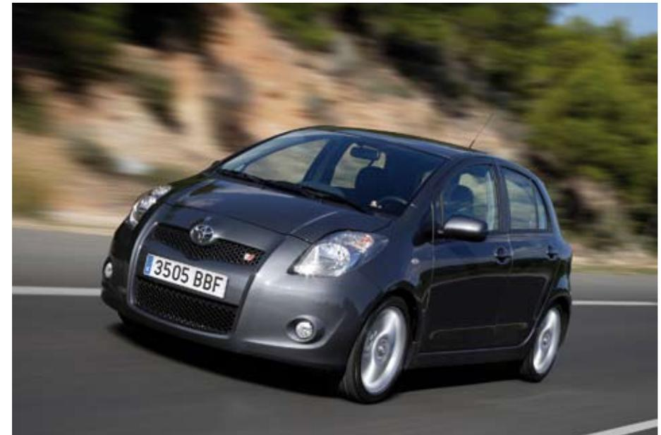
Der Yaris TS ist mit einem völlig neu entwickelten 1,8-Liter-Benzinmotor mit Dual VVT-i ausgestattet, der für ein Höchstmaß an Fahrdynamik und Laufkultur sowie für einen äußerst geringen Kraftstoffverbrauch bürgt. Das neue Kraftpaket mit variabler Ventilsteuerung auf Einlass- und Auslass-Seite verhilft dem Yaris TS mit einer Spitzenleistung von 133 PS (98 kW) bei 6.000/min zu höchst respektablen Fahrleistungen.
