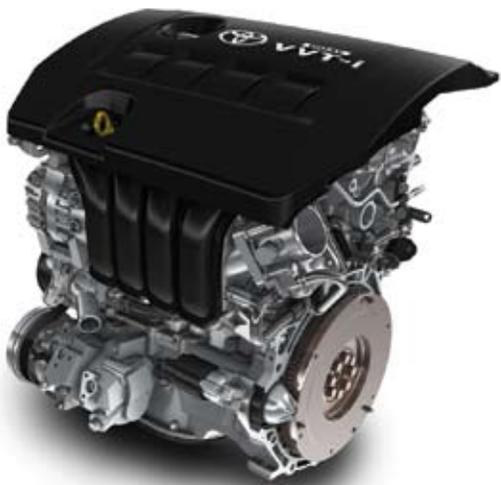
Innovative Technik bildete von jeher das zentrale Merkmal der Yaris Motorenpalette. Bereits der Einstiegs-Benziner mit 1,0 Liter Hubraum ist mit der variablen Ventilsteuerung VVT-i ausgerüstet und verbindet geringes Gewicht und kompakte Abmessungen mit beachtlichen 51 kW (69 PS) Leistung bei 6.000/min.
