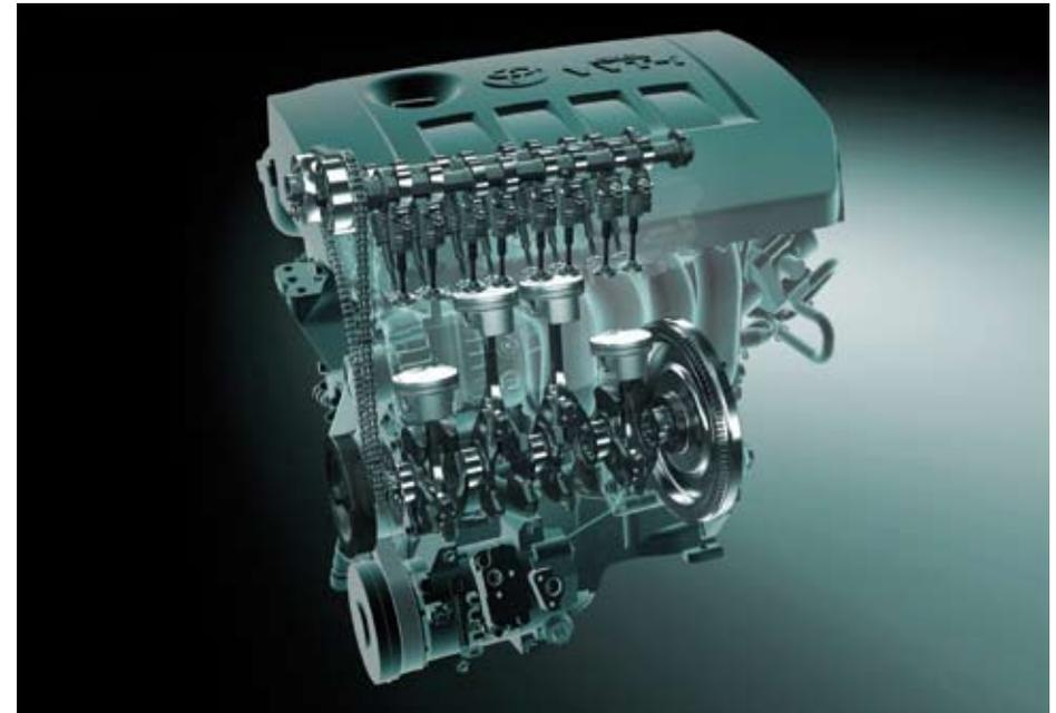
Rollenkipphebel minimieren die Reibung zwischen Nockenwelle und Ventilmechanismus, wartungsfreie Hydrostößel sorgen für einen automatischen Ventilspielausgleich.
