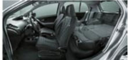
Se ha suprimido el usual túnel para el sistema de escape del piso trasero del nuevo Toyota Yaris, adoptando por tanto **una configuración más plana** – algo que mejora enormemente el confort del pasajero del asiento trasero central. Esto se ha conseguido facilitando, de manera ingeniosa, un nuevo recorrido al tubo de escape, lo que ha permitido realizar un diseño nuevo del plano del piso.
